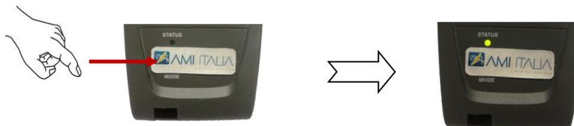
Das Einschalten des Druckers wird durch das asynchrone Blinken der drei LEDs und durch das Einschalten der ersten LED mit grünem Dauerlicht bestätigt.
