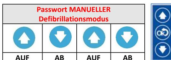
Geben Sie das Passwort in der oben beschriebenen Reihenfolge ein. Während Sie die Sequenz eingeben, ändern sich die Bindestriche an der Seite des Eintrags "Passwort eingeben" in Sternchen. Wenn die Sequenz abgeschlossen ist, wird automatisch der EKG-Überwachungsmodus gestartet.
