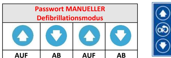
Geben Sie das Passwort in der oben beschriebenen Reihenfolge ein. Während Sie die Sequenz eingeben, ändern sich die Bindestriche an der Seite des Eintrags "Passwort eingeben" in Sternchen. Wenn die Sequenz abgeschlossen ist, wird automatisch der gewünschte manuelle Defibrillationsmodus eingeleitet.
